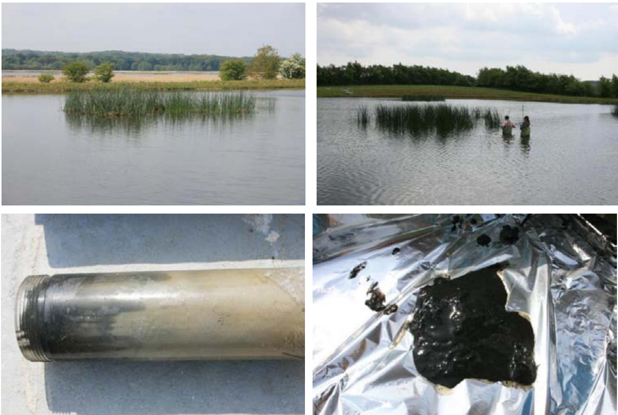
Figur 4. Fotos af prøveudtagning. Øverst ses udtagning af prøver fra bassinet i Århus. Nederst tv ses en sediment kerne og til højre en udvalgt prøve til nærmere analyse.
