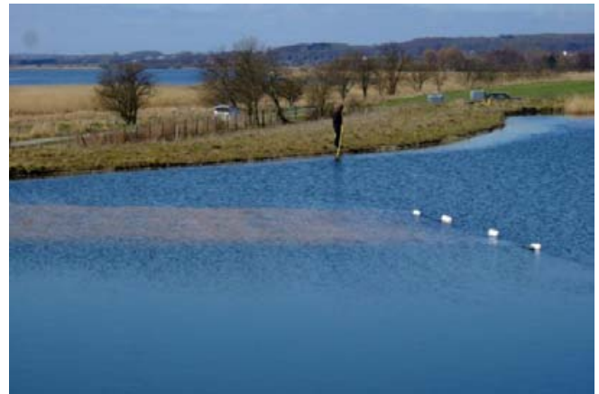
Figur 2 Tilsætning af jernsalte til bassinet i Århus. Der blev tilsat 3 tons opløst jernsalte.
